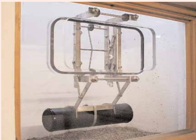
Automatisches Hochwasserschutzfenster mit Schwimmersteuerung
