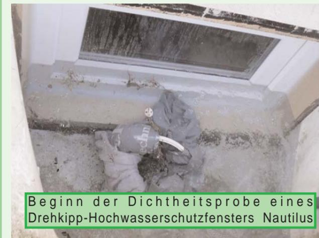
Beginn der Dichtheitsprobe eines Drehkippen-Hochwasserschutzfensters Nautilus
