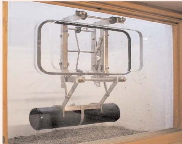
Automatisches Hochwasserschutzfenster mit Schwimmersteuerung
